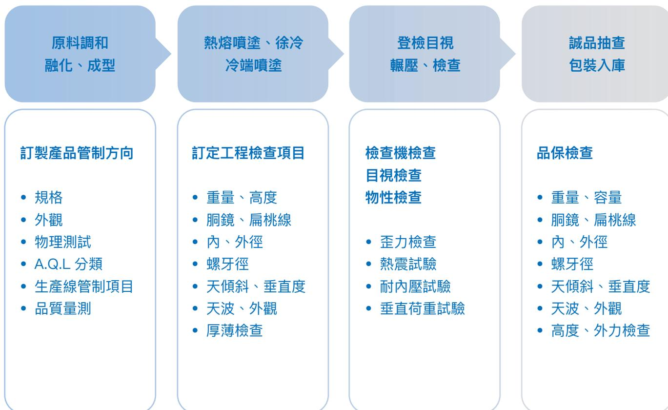
從矽沙高溫熔融為玻璃膏到注入模具後冷卻成型，玻璃容器的生產製作是一連串繁複的生產製造工藝，我們重視每個環節，結合「人員檢查」和「自動化檢查設備」，並經過實驗室檢測，以確保品質和兼顧效率，展現完美，滿足客戶的需求。
