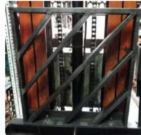
加裝防捲夾安全防護措施
