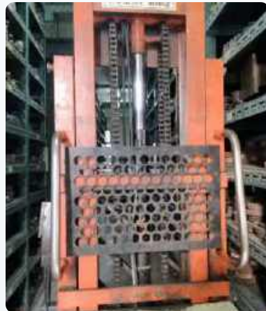
加裝防捲夾安全防護措施
